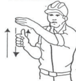
4 Levantar el aguilón o pluma lentamente
