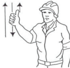
4 Levantar el aguilón o pluma lentamente
